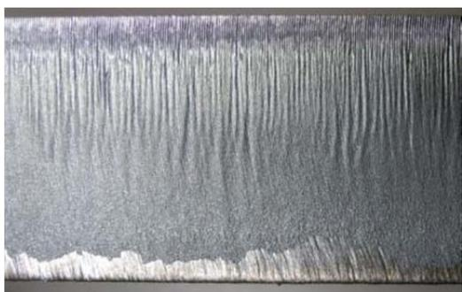
5kW ファイバレーザ 板厚：軟鋼 32mm 速度：550 mm/min
