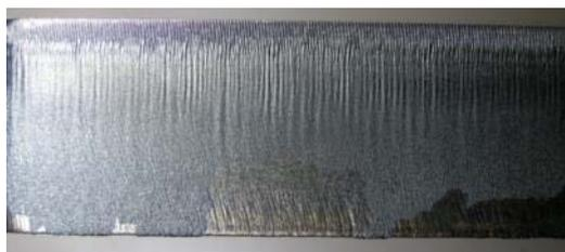
5kW ファイバレーザ 板厚：軟鋼 25mm 速度：650 mm/min
